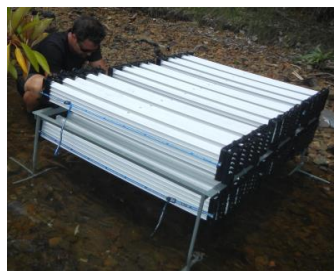
Image 2 : Un collecteur Zapco composé de 25 lames de PVC (gauche) et une unité de collectage assemblée (droite)
