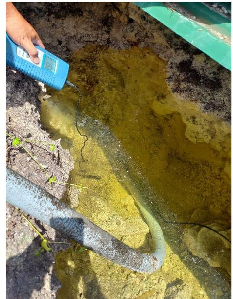
Figure 7 : mesure de la salinité de l'eau de la lentille
