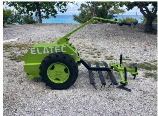
Figure 9 : prototype de motoculteur électrique testé à Fakarava
