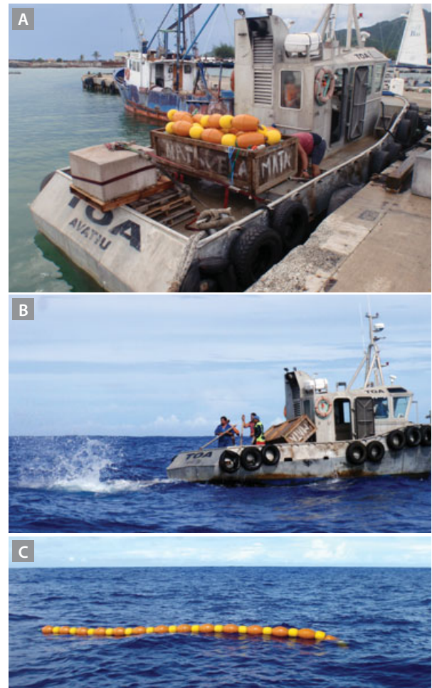
Figure 4. A: Un DCP est chargé sur le remorqueur Toa. Il est prêt à être mouillé au large des côtes. B: Mise à l'eau du corps-mort du DCP. C: DCP éloigné au large de Ngatangia, prêt à concentrer le poisson
