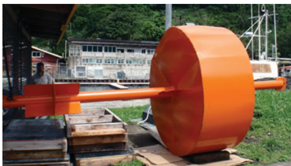
Figure 5. Bouée espar utilisée pour les DCP aux Samoa américaines
