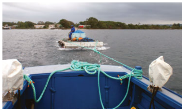
Figure 7. Remorquage du DCP immergé sur une barge vers le site de mouillage
