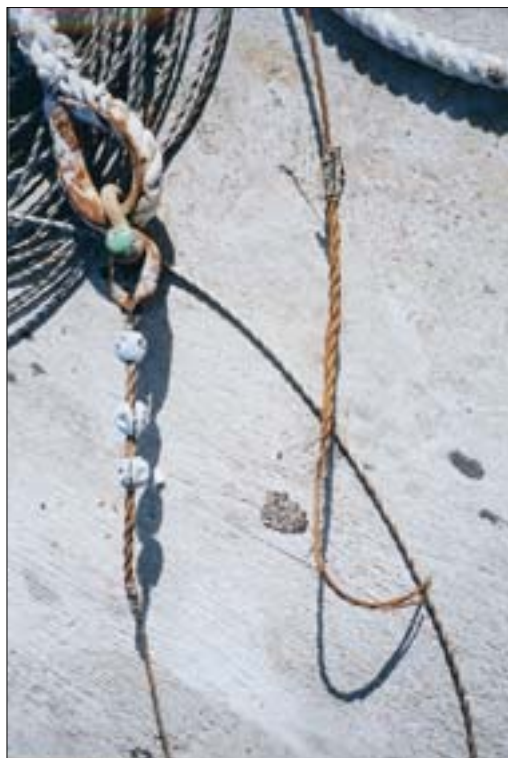
Le câble de 9,0 mm de diamètre en acier s'est rompu
