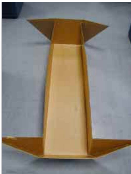
Figure 7: La double-paroi pliée du carton étanche
