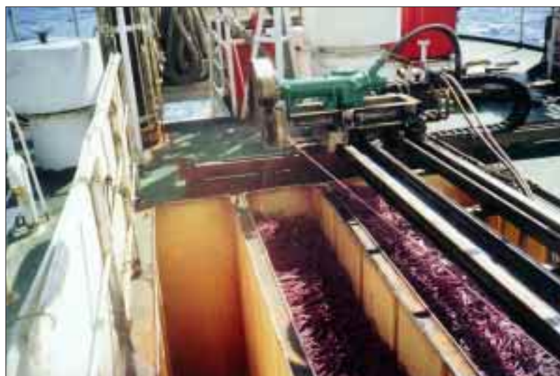
Figure 7 : La ligne-mère est répartie dans les compartiments du bac d'entreposage
