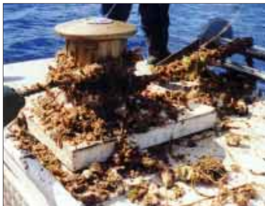
Figure 3 : Les bouées gonflables font remonter le mouillage à la surface
