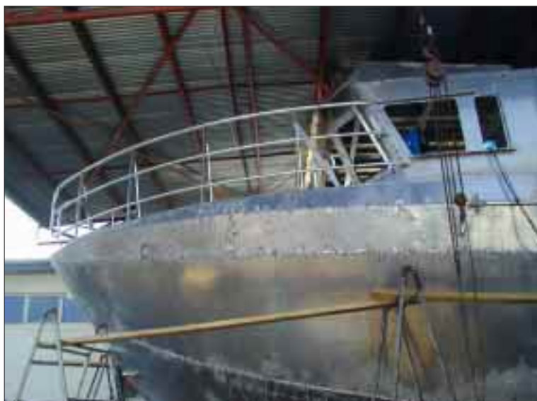
Figure 1 : Un palangrier Warren de 18 mètres, en construction
