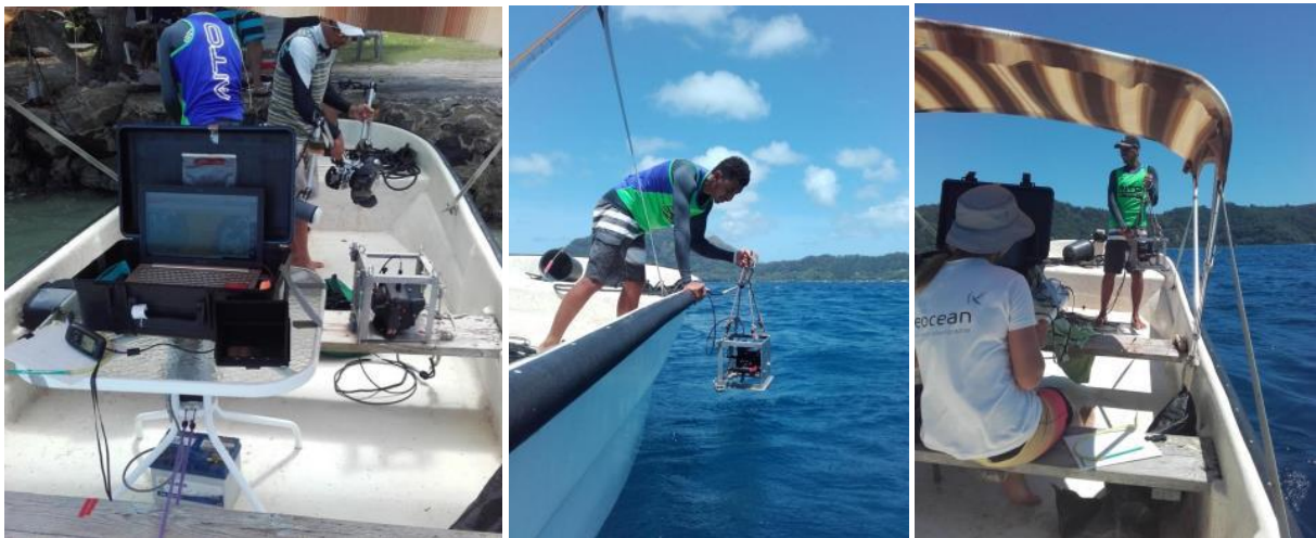
Installation sur le bateau (logiciel de navigation) et mise à l'eau de la caméra (©Créocéan)
