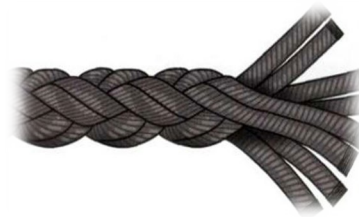
Figure 16 : Schéma d'un cordage tressé (seulement une âme)
