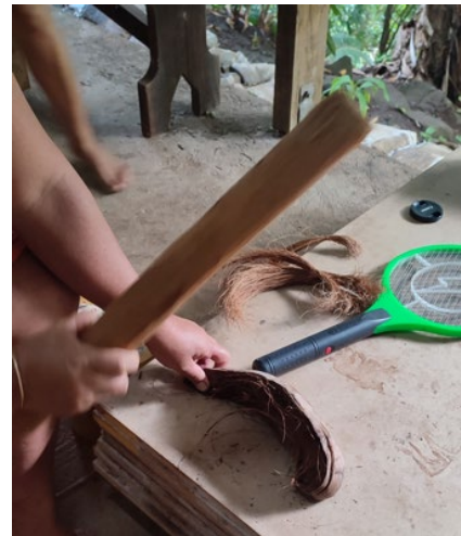
Figure 10 : Action de défibrage avec une masse
