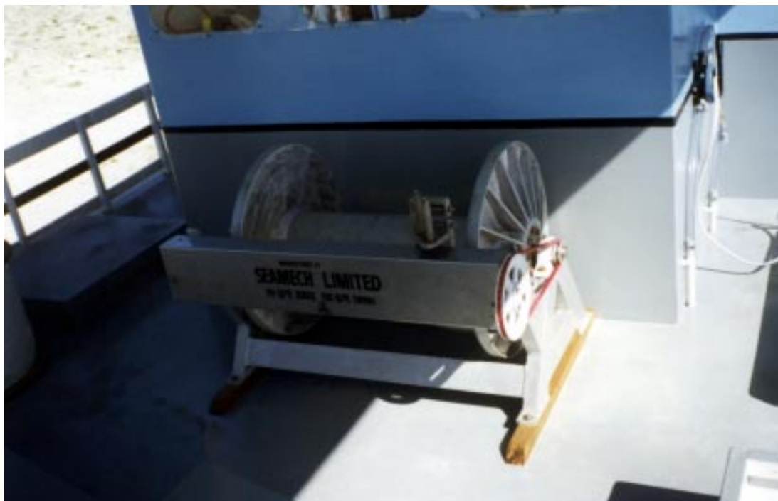
Figure 1: Enrouleur de palangre installé sur le Tekokona II
