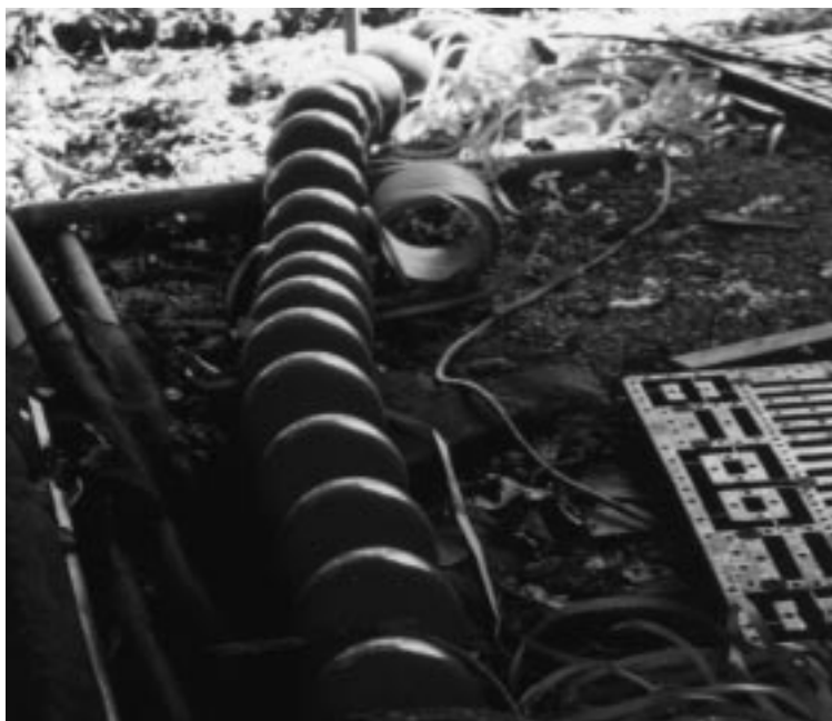
Figure 4 : Partie flottante du DCP composée de bouées montées en série.
