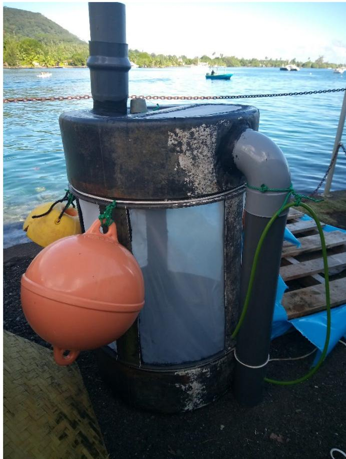
*Figure 18: pompe à plancton à faible tirant-d'eau, premier modèle*
