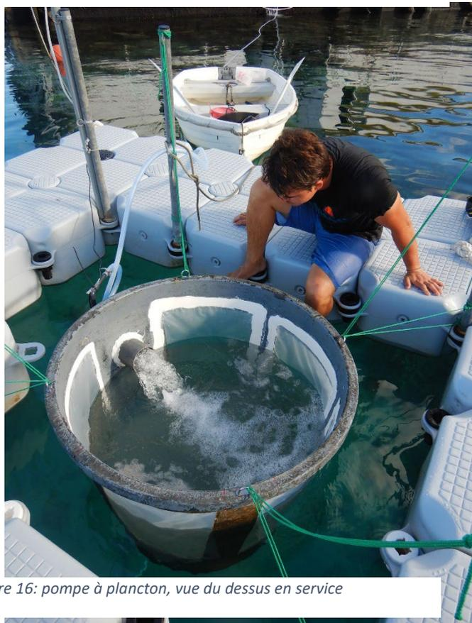
Figure 16: pompe à plancton, vue du dessus en service
