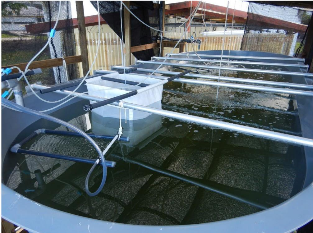
Figure 4: bassin de 7m<sup>3</sup> avec panier flottant
