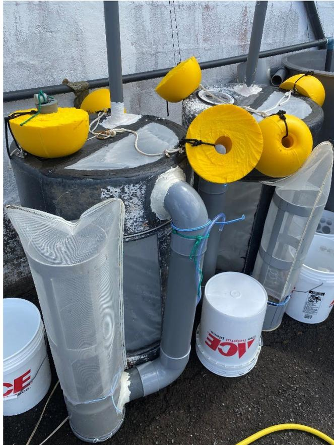
Figure 19: pompe à plancton à faible tirant-d'eau, deuxième modèle
