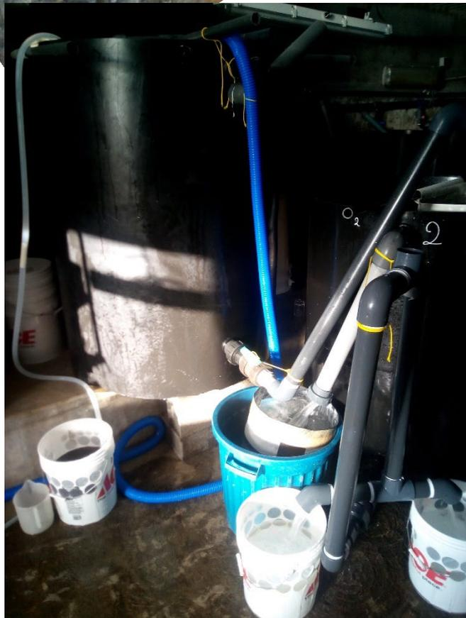
*Figure13-14: pompe vide-cave et dispositif de séparation des planctons en cascade*
