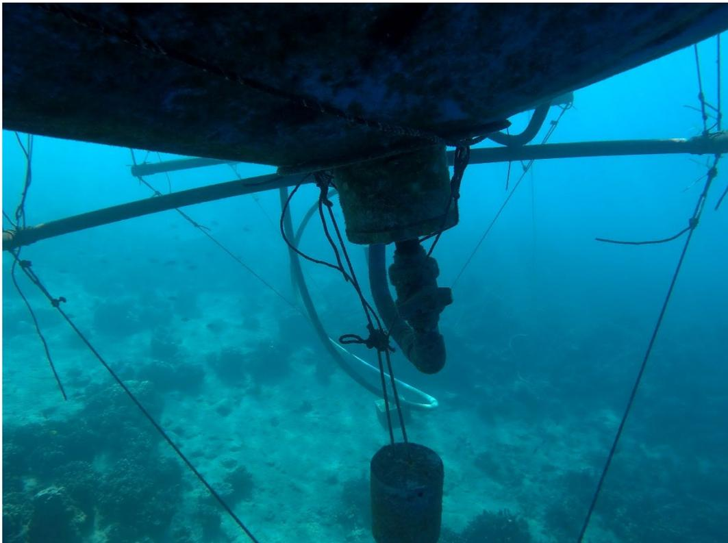
*Figure 12: purge basse à airlift d'un tarpaulin immergé*
