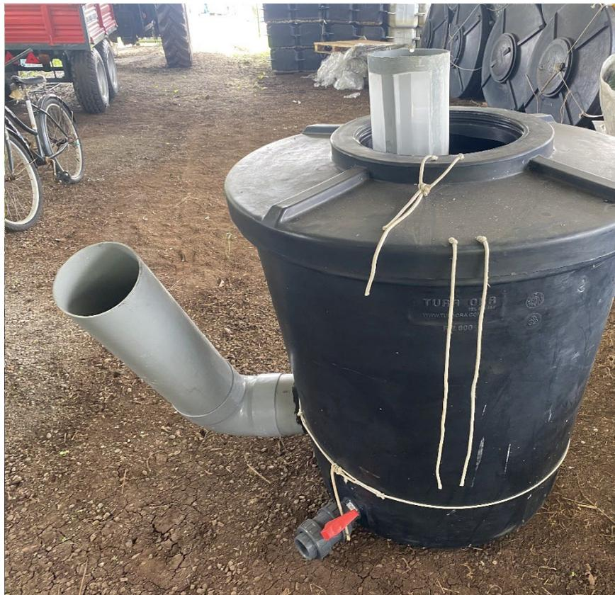
Figure 35 : récolteur/rinceur de 700l pour le kit de pompage mobile (pompe à membrane thermique)
