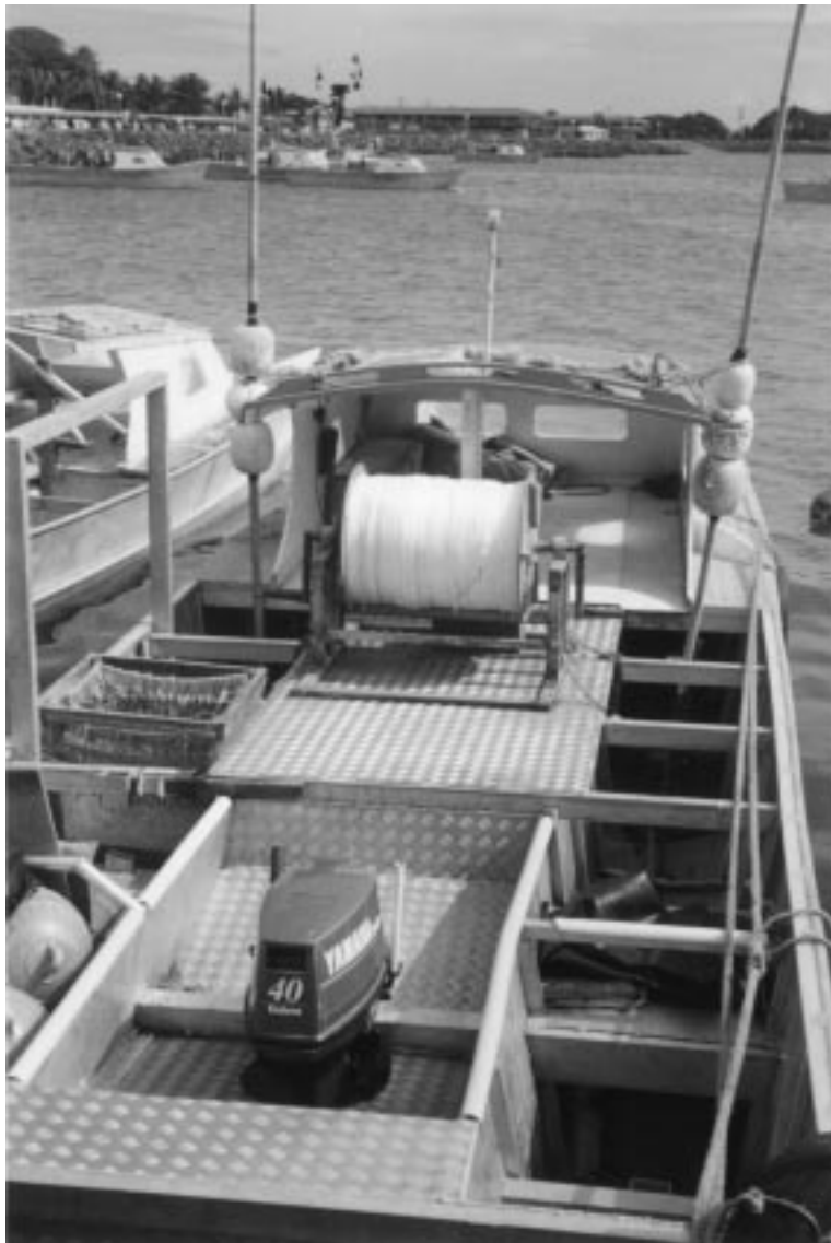
Un alia équipé pour la pêche thonière à la palangre : on aperçoit l'enrouleur manuel pour la palangre, une caisse à avançons, des flotteurs et deux perches porte-pavillon
