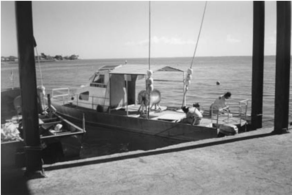
Aménagements sur le catamaran alia : plus d'espace sur le pont, timonerie à l'avant, deux moteurs hors-bord
