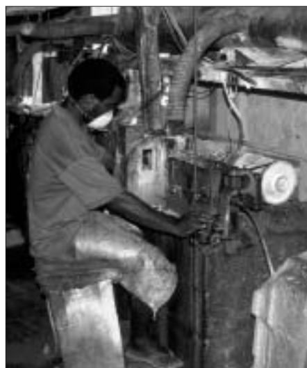
Figure 3. Un ouvrier poinçonne une coquille
