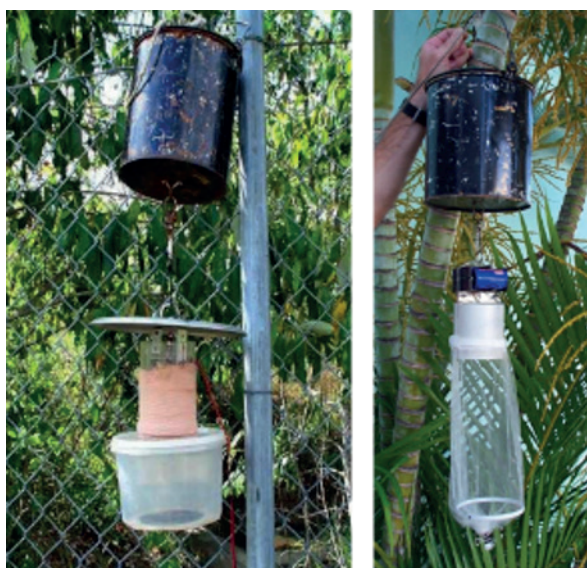
Figure 11 : à gauche : piège lumineux des CDC. À droite : piège EVS. Sur les deux images, de la neige carbonique (source de CO 2 ) a été placée dans la boîte noire.
