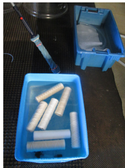
Désinfection des filtres à cartouche
