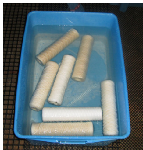
Désinfection des filtres à cartouche
