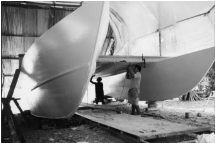
Figure 4 : Fixation du pont du nouveau catamaran en construction à Kiribati.
