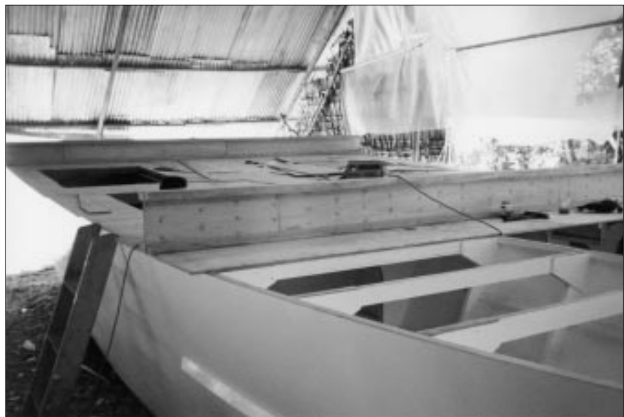
Figure 5 : Le pont du nouveau bateau avant la construction de la cabine.
