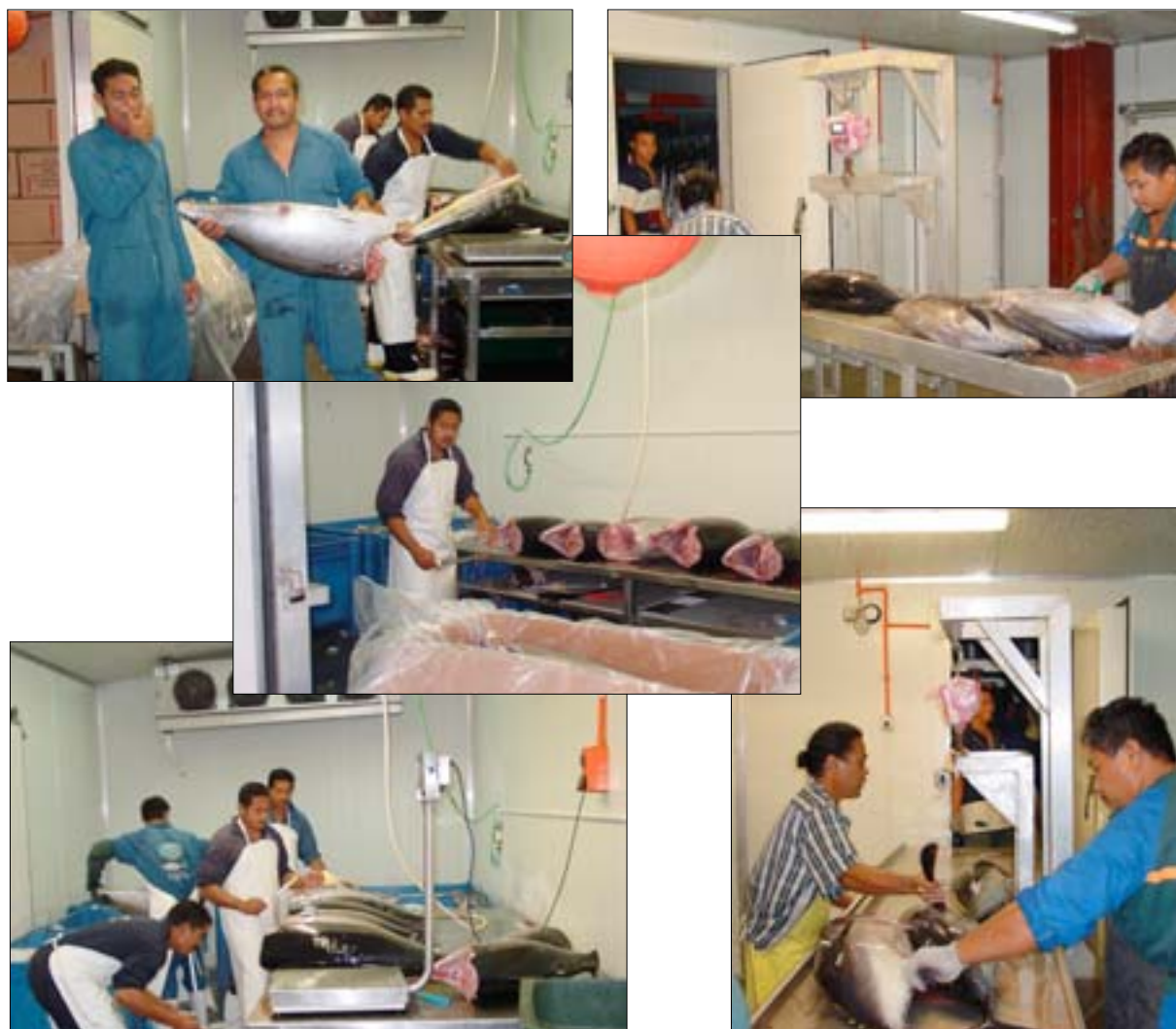
À gauche et au centre : Le classement et l'emballage du thon jaune et du thon obèse étêté et éviscéré chez Apia Export Fish Packers (Samoa). À droite : Le nettoyage du germon avant la congélation chez Tradewinds Fish Co. (Samoa) [Photos: Michel Blanc]
