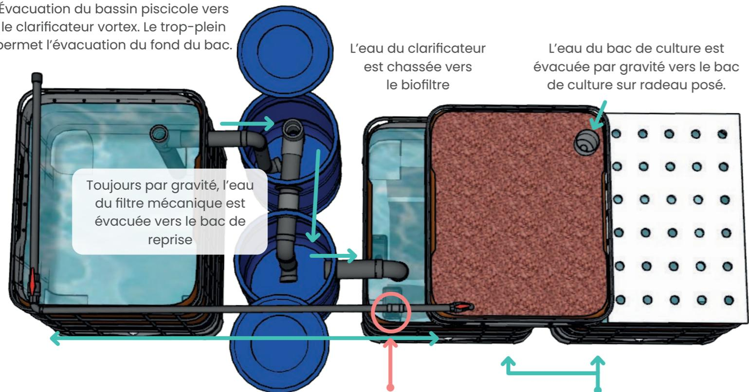
L'eau du clarificateur est chassée vers le biofiltre
