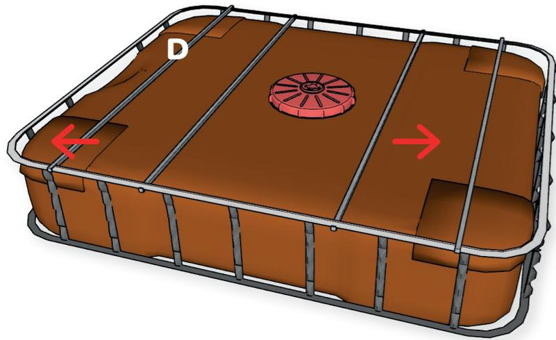
Replacer la partie haute de la cuve D dans sa cage.
