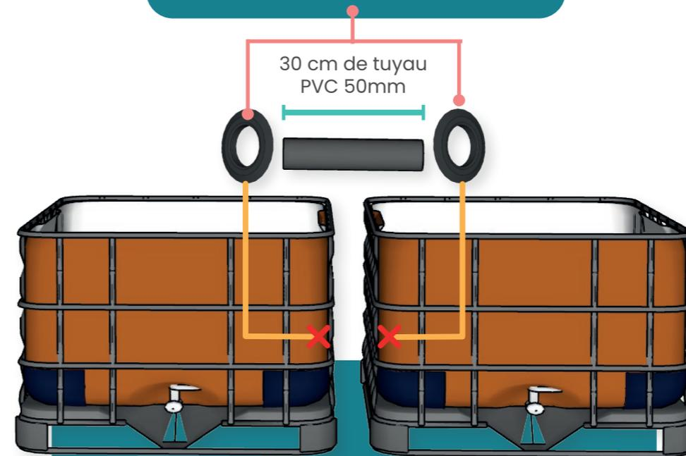
Percer 2 trous alignés à l'aide de la perceuse et de la scie-cloche 64 mm. Il est recommandé de viser à mi-hauteur de la cuve en se plaçant bien au centre d'un des carreaux de la cage.
