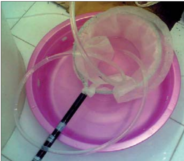
Figure 1. Siphonnage de l'eau du bac à travers un tamis.
