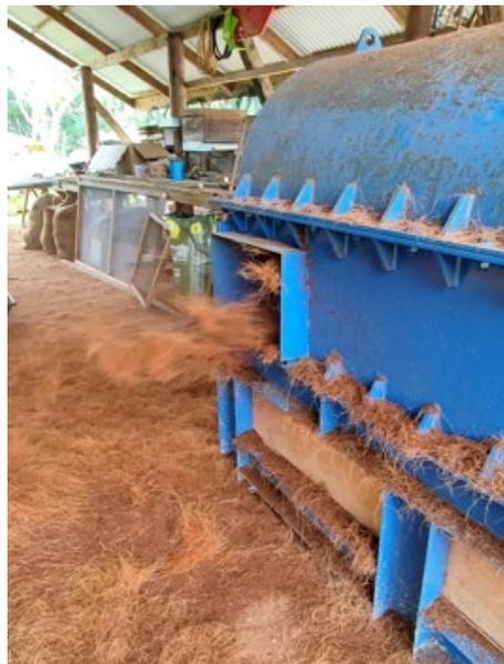
Figure 6 - Fibres longues en sortie de défibreuse
