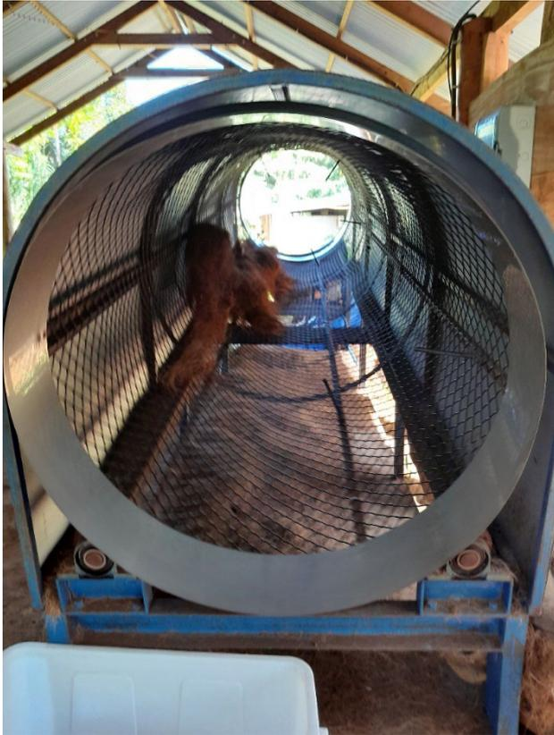
Figure 9 – Fibres à l'intérieur du tamis
