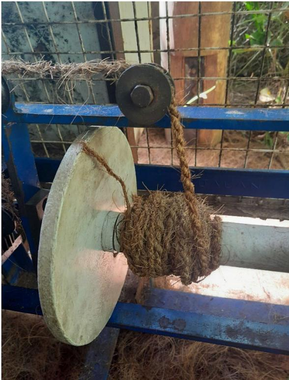
Figure 19 – Bobinage et fil toronné
