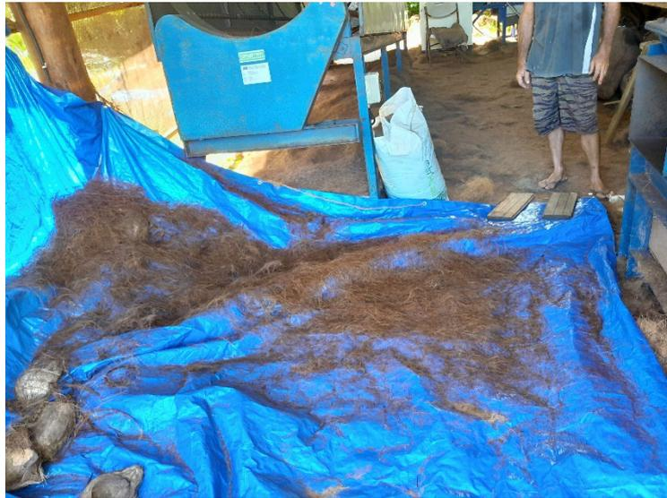
Figure 7 - Fibres longues en sortie de défibreuse
