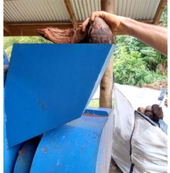
Figure 5 - Chargement de la défibreuse
