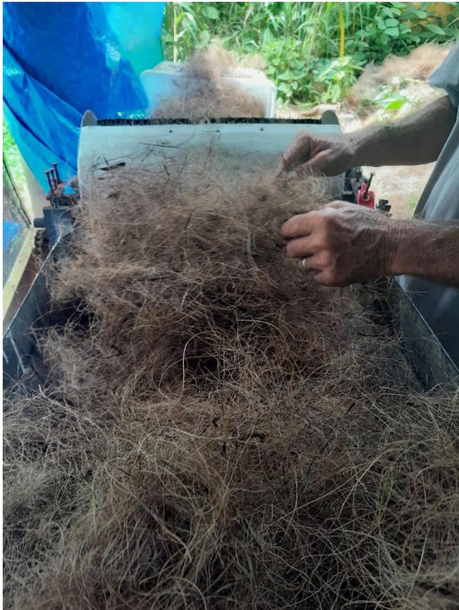
Figure 13 - Chargement des fibres dans le peigne
