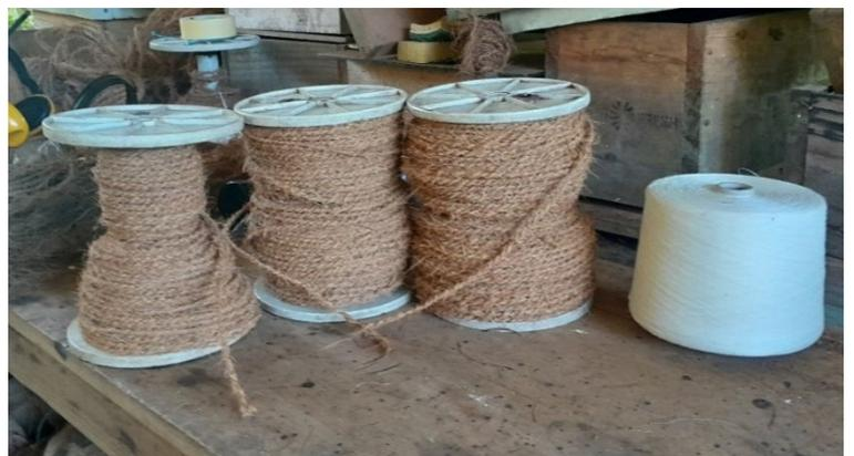
Figure 18 – Bobines de fils toronnés et bobine de guide (fil de lin à droite)
