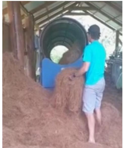
Figure 8 - Chargement de fibres dans le tamis
