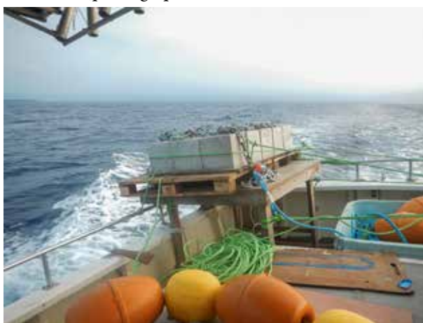
Photographie 9 : plateforme embarquée de mise à l'eau des corps-morts, avec deux configurations distinctes.
