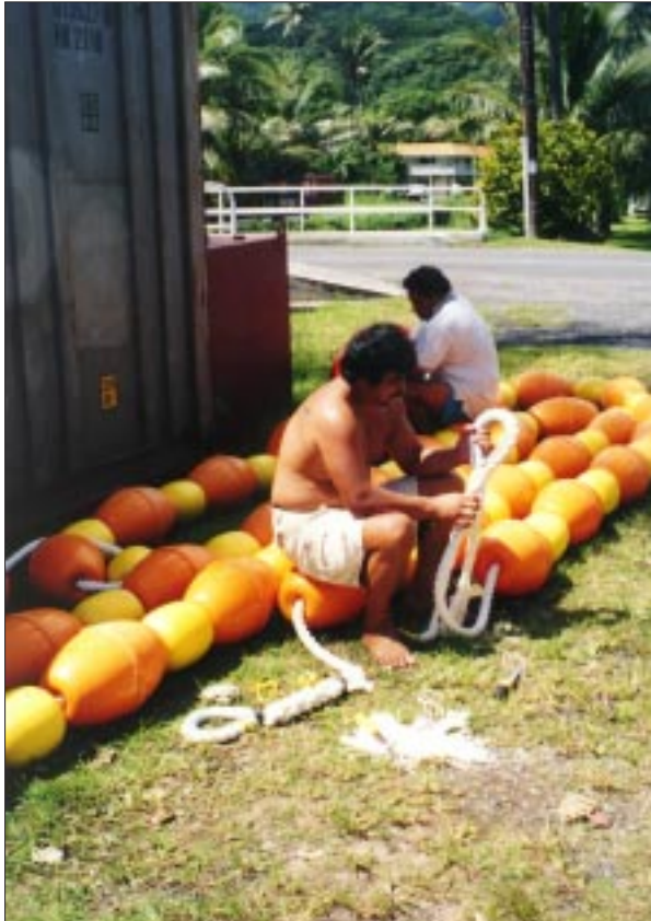
Figure 2: Montage de bouées destinées à un DCP de grande profondeur [Photo: Lindsay Chapman]
