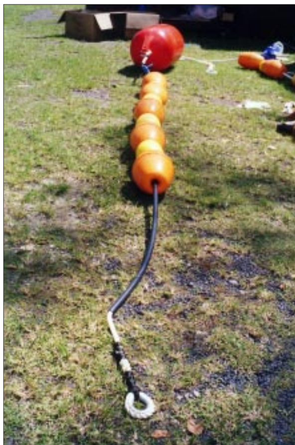
Figure 1: Montage de bouées destinées à un DCP de faible profondeur [Photo: Lindsay Chapman]
