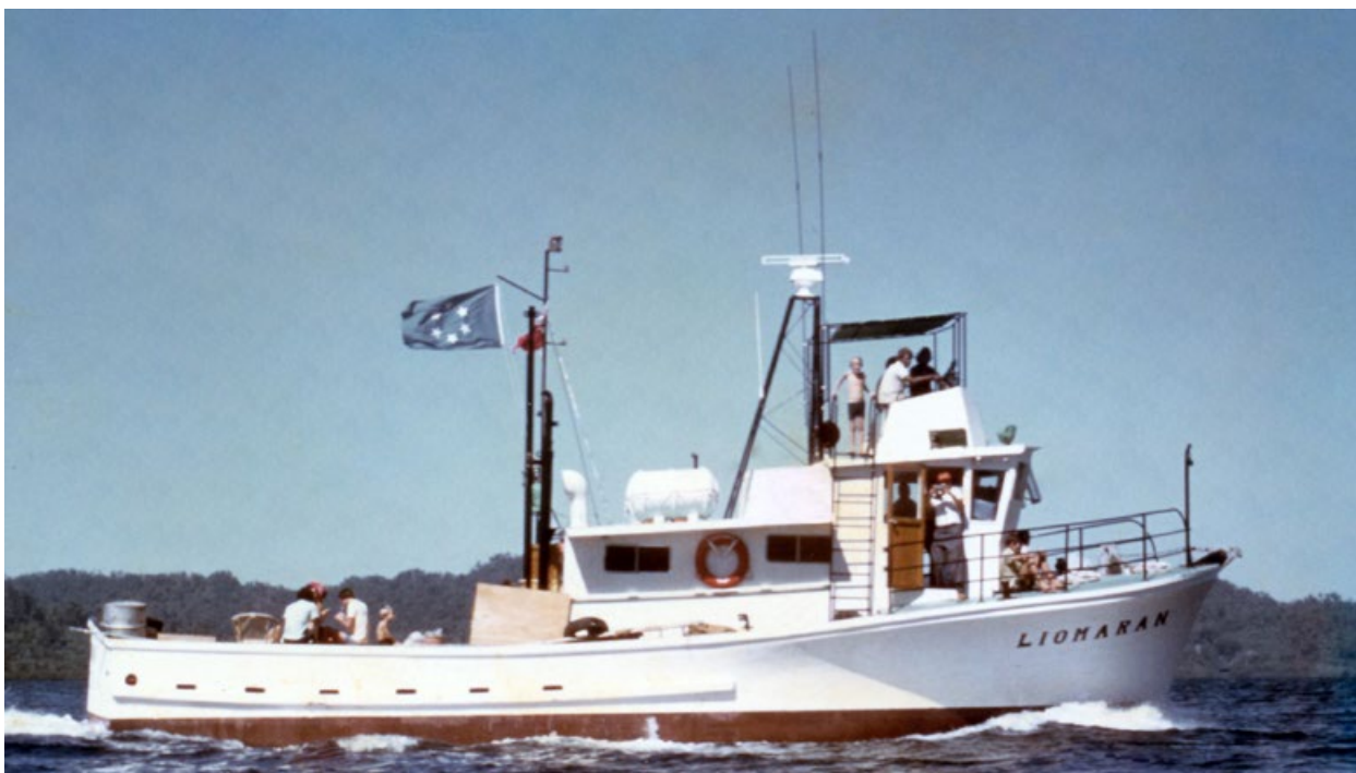
Le Liomaran , bateau de pêche en ferrociment de 16,2 mètres construit en 1974 pour le bureau du district de Yap de la Division ressources marines du Territoire sous tutelle, lors d'essais en mer à Tulagi, aux Îles Salomon (photo : M. McCoy).
