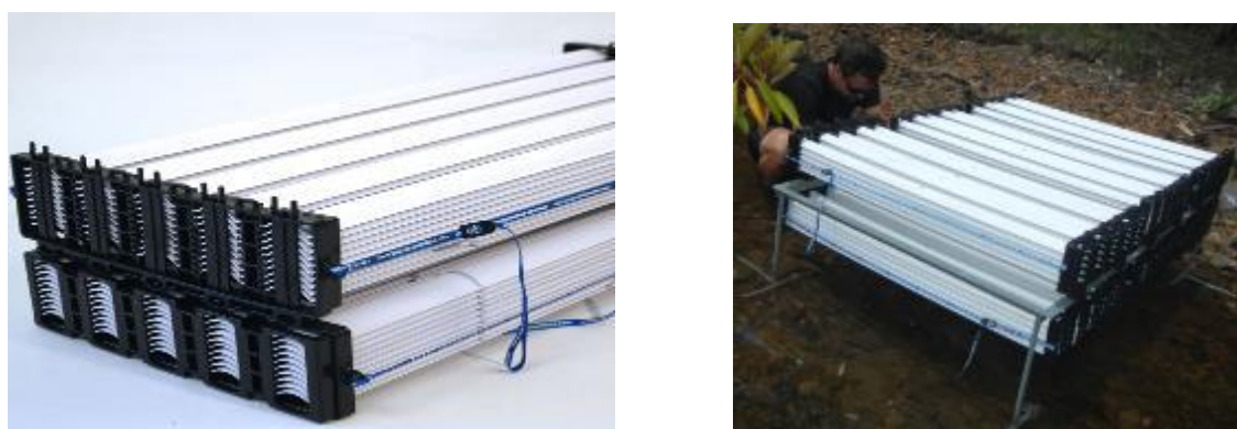
Figure 56. Un collecteur Zapco composé de 25 lames de PVC (gauche) et une unité de collectage assemblée (droite)
