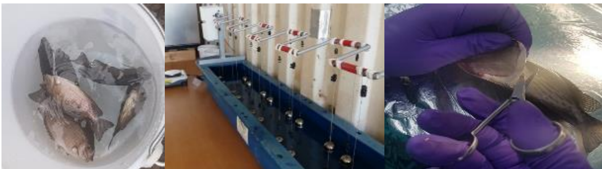
Figure 9. De gauche à droite, des picots rayés anesthésiés pour peser, système de mesure de la lixiviation des aliments et dissection d'un picot rayé en fin d'essai.
