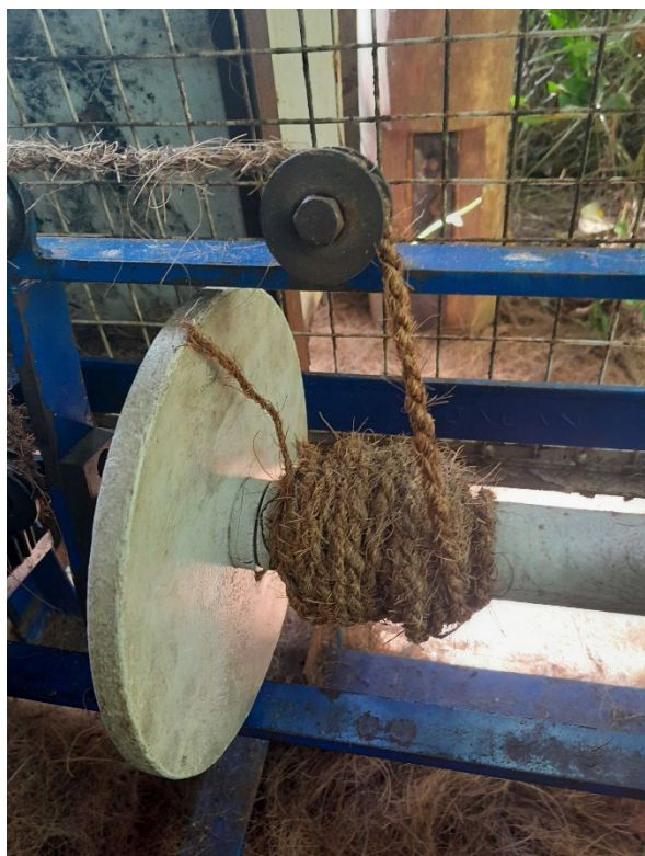
Figure 19 – Bobinage et fil toronné
