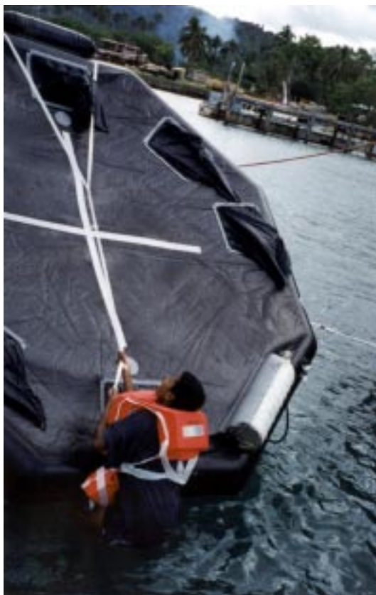
Redressement d'un radeau de survie
