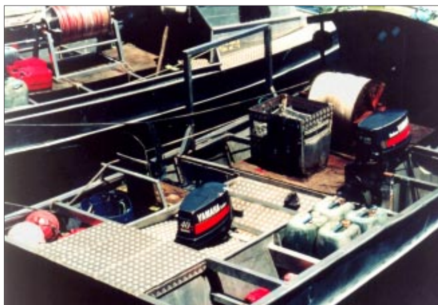
Figure 1: Bateau de 9 mètres de type alia, propulsé par des moteurs hors-bord
