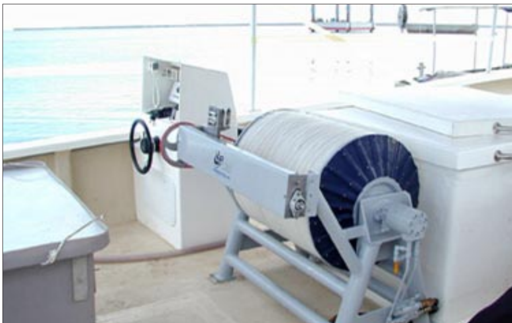
Un palangrier de 11 mètres : l'enrouleur Lindgren-Pitman de 0,61 x 0,69 mètre, à côté du poste de commande. La glacière isotherme est située juste à l'avant de l'enrouleur et une caisse à avançons est calé juste à l'arrière.
