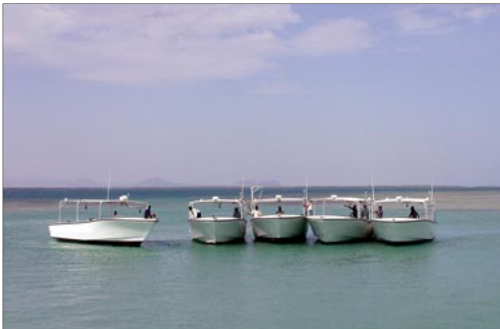
Ces cinq palangriers de 11 m, sortis du Chantier Harena de l'île de Halib en Érythrée, sont tous équipés d'enrouleurs Lindgren-Pitman pour palangre à monofilament et de moteurs semi-hors-bord Volvo-Penta de 105 cv.
