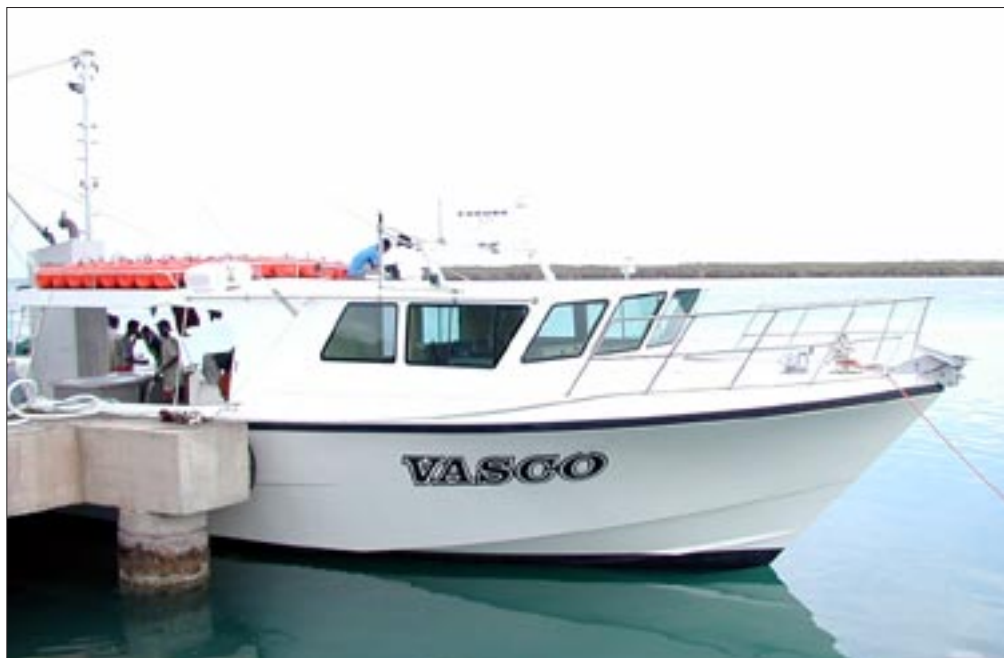
Le Vasco , premier d'une nombreuse série de palangriers de 18 mètres sortis du chantier naval Harena. Il est équipé d'un enrouleur de gros calibre Super Spool de Lindgren-Pitman de 1 x 1, 2 mètre, d'un éjecteur LS-4 et d'un moteur diesel Caterpillar 3406.
