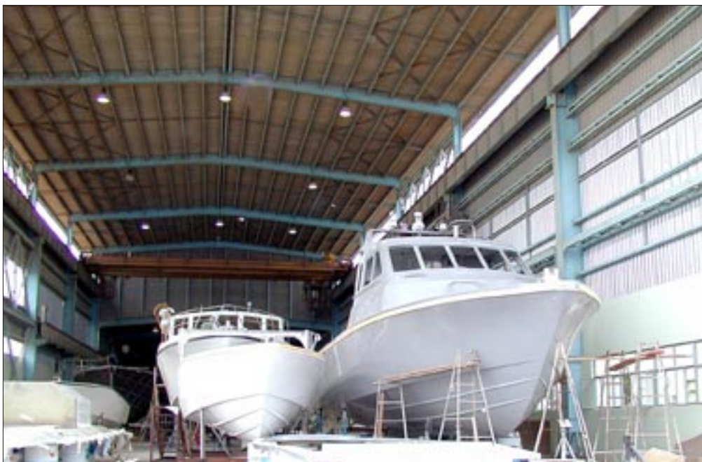
Le hangar à bateau du Chantier Harena abrite plusieurs bateaux en cours de construction. Au premier plan, un garde-côte de 17 mètres, un palangrier de 11 m et derrière lui, un de 18 mètres.
