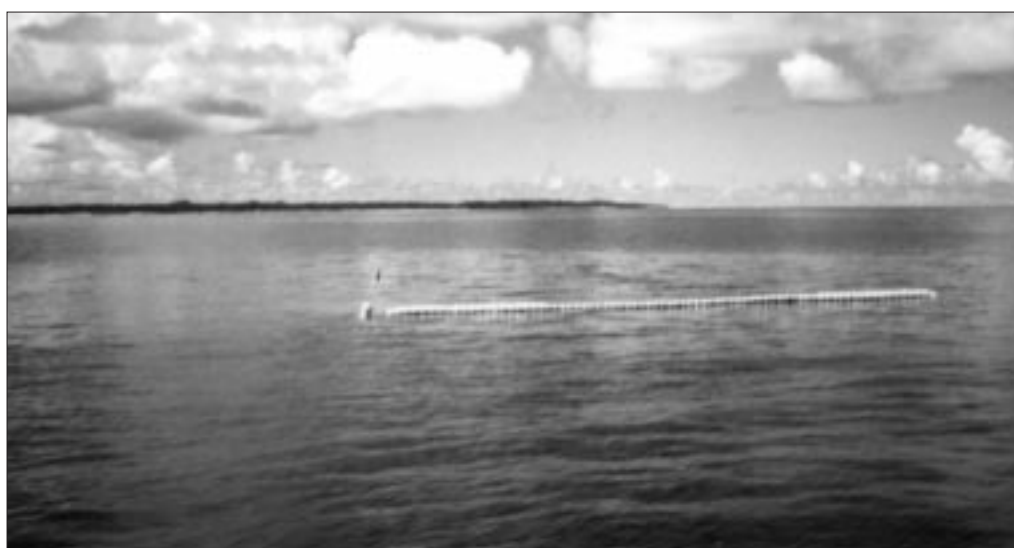
Figure 4 : Un radeau de type océan Indien mouillé à 2 450 mètres de profondeur, à 3.5 milles environ de Nauru
