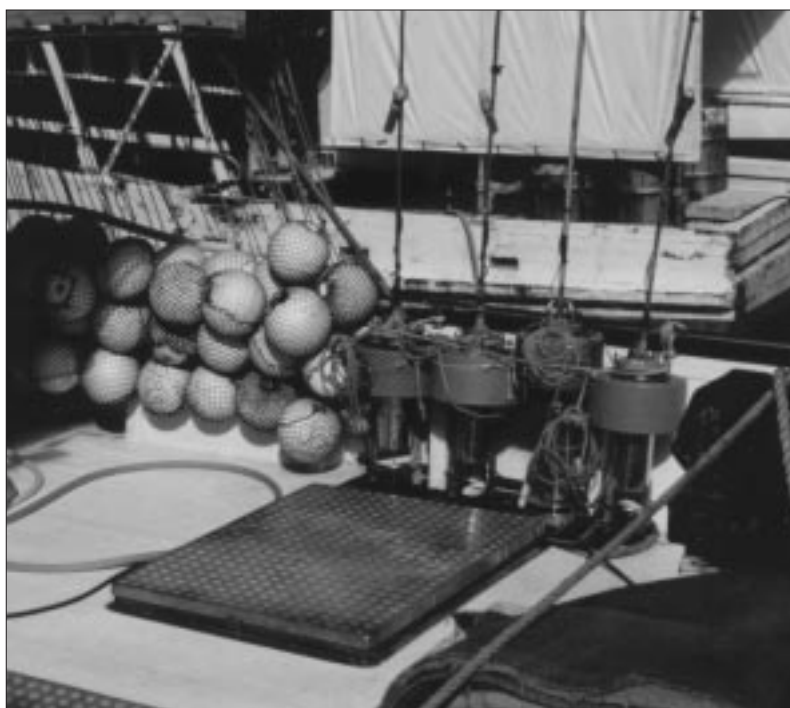
Figure 4 : Les balises radio portant des feux clignotants et les flotteurs utilisés pour la pêche à la palangre
