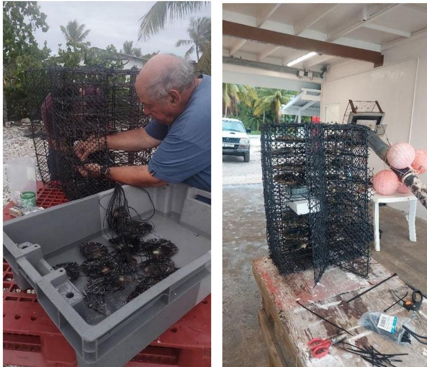
**Figure 15 :** Installation en cage des HP connectée / Cage et valvomètre avant installation
