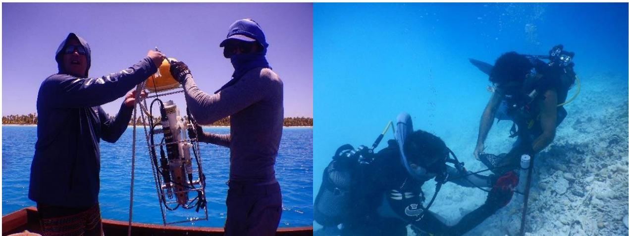
**Figure 12** : Profilage verticaux et installation de capteur dans lagon de REAO
