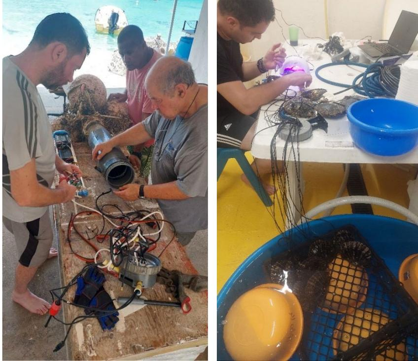
**Figure 14 :** Entretien du Valvomètre de Takapoto / Collage des électrodes sur les HP
