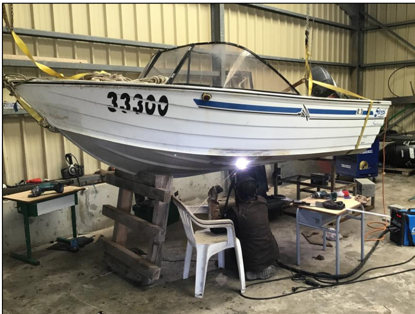
Figure 4 : Soudure coque - Ouvéa
