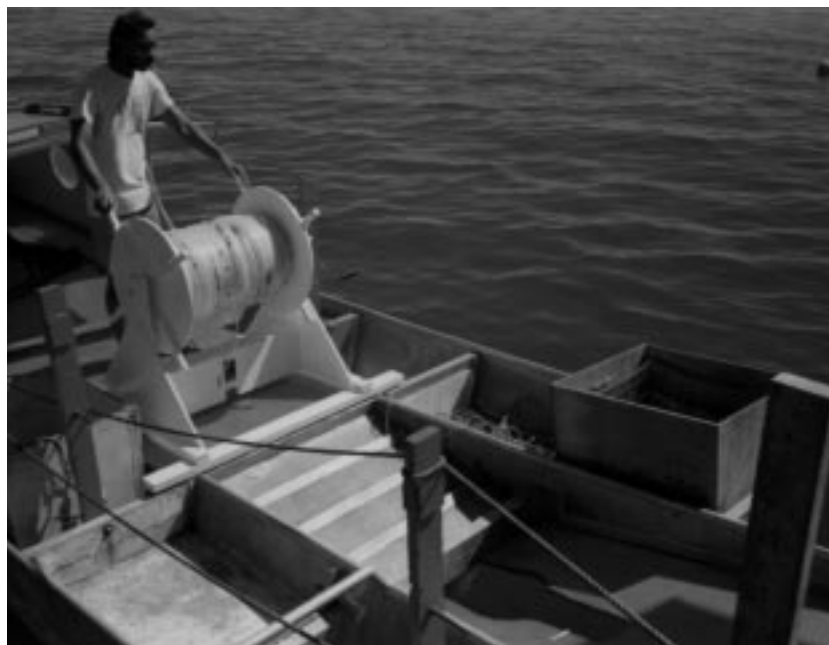
Figure 4 : Moulinet en bois monté sur un catamaran alia , pour la pêche à la palangre verticale.
