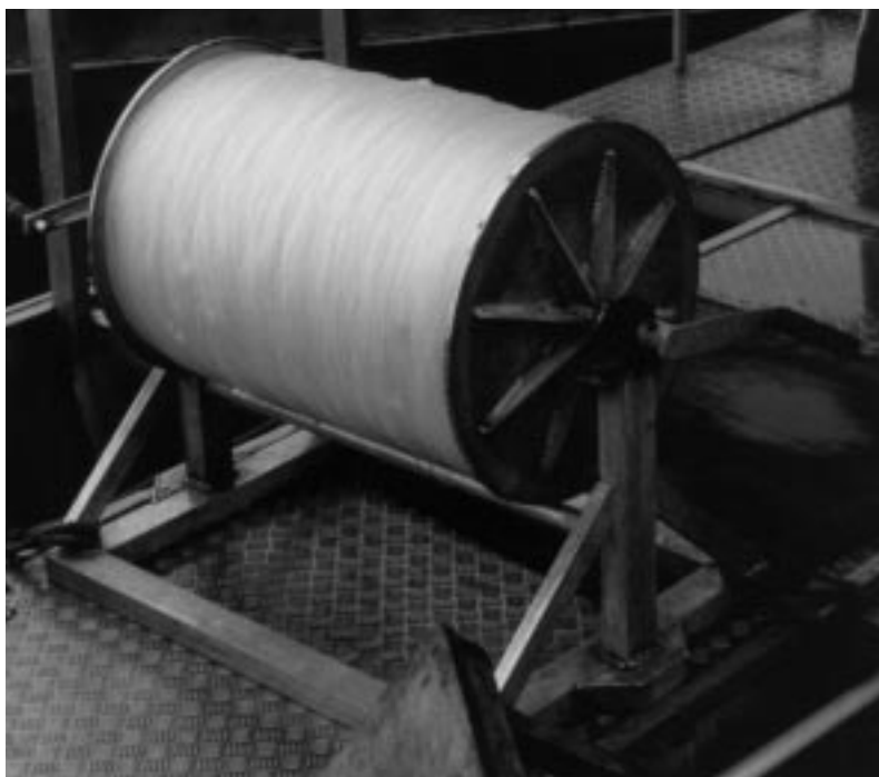
Figure 10 : Enrouleur de ligne en aluminium équipé d'une manivelle à chaque extrémité
