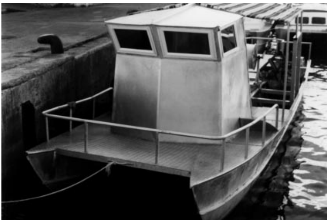
Figure 7 : Cabine en aluminium montée sur un catamaran alia version longue de 10,5 mètres.
