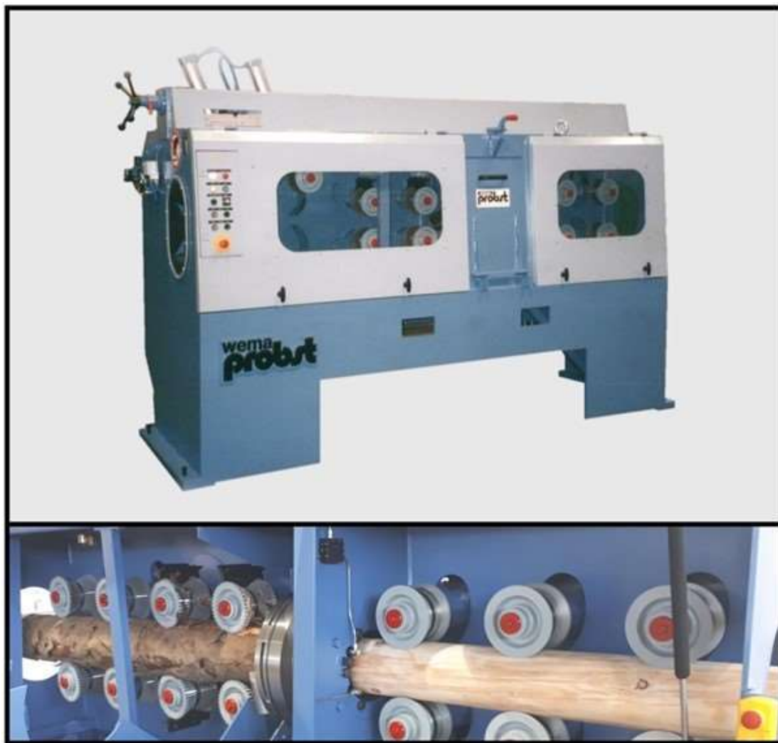
Figure 8. Machine à rondiner WEMA PROBST®, modèle RHM 160 I-H pour une production de bois de diamètre inférieur à 160 mm.
