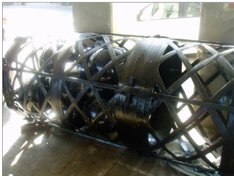
Figure 9 : cage en plastique renforcé d'un DCP immergé, deux fois moins grande que celle d'un DCP de surface
