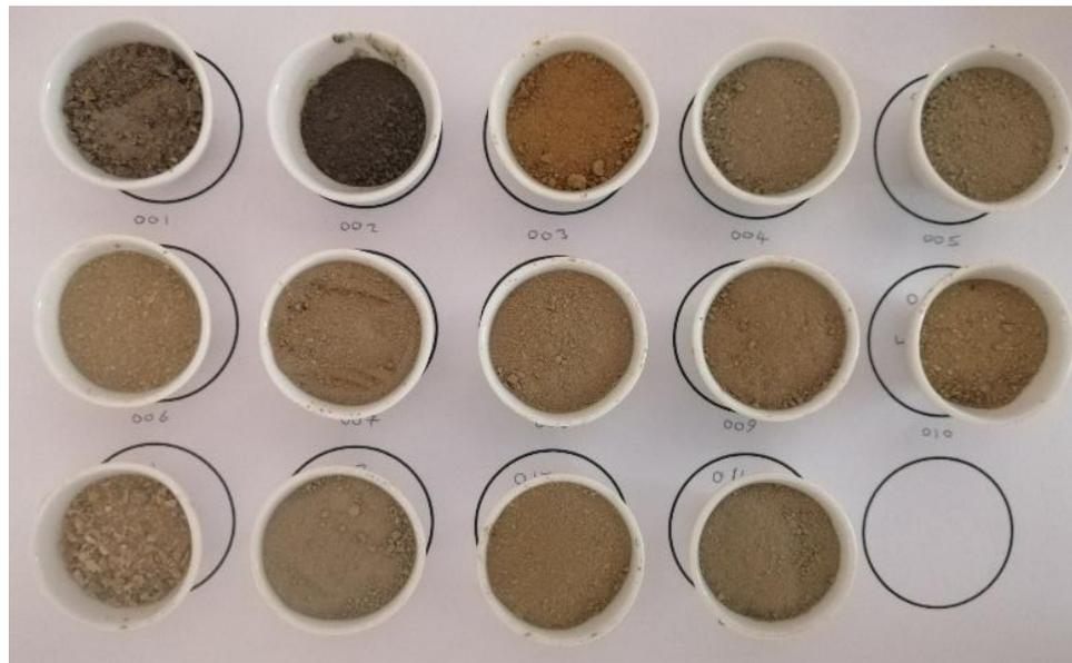
Figure 8 : Photographie des 14 échantillons de sols secs dans des creusets avant les analyses de perte au feu
