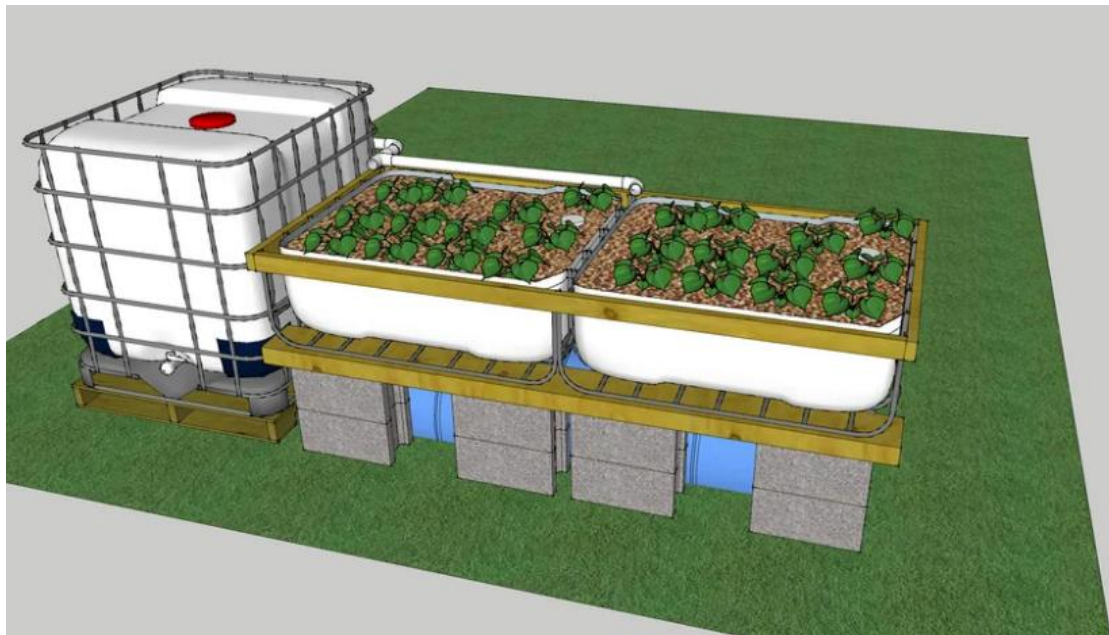
Figure 30 : un système aquaponique réalisé à partir de 2 cuves ICB et de futs bleus de 200l coupés en 2 qui servent de bacs tampons. L'apport d'eau se fait ici par surverse
