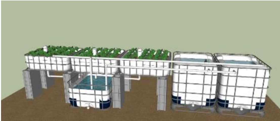
Figure 31 : Système aquaponique réalisé à partir de 4 cuves ICB, le bac tampon est fait avec une demi cuve, l'apport d'eau dans les bacs plantés se fait par surverse
