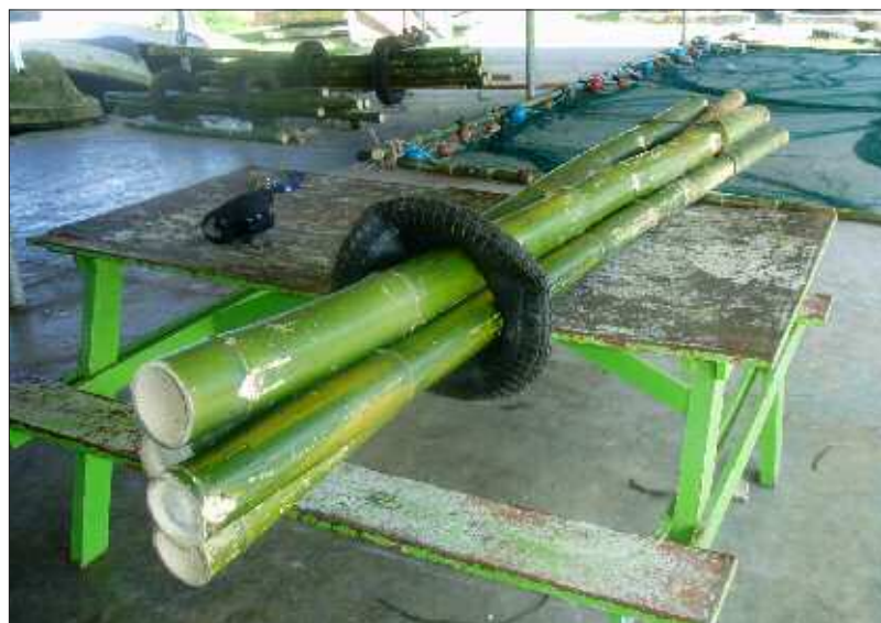
Figure 1 : Assemblage du radeau du DCP à l'aide de bambous et d'un pneu
