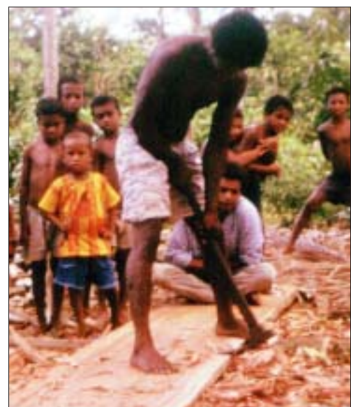
Figure 8. Le premier travail sur les bordés est fait en forêt avec une herminette (M. Smaalders, 1997)
