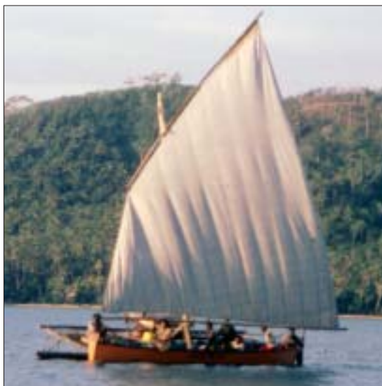
Figure 10. Toutes les pirogues de Louisiade portent des gréements de lougre (M. Smaalders)
