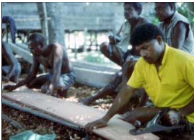
Figure 9. Les bordés sont lissés au rabot (M. Smaalders, 1997)
