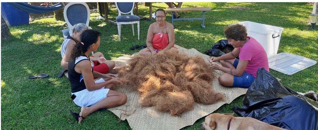
Figure 11 - Tri manuel des fibres pour en retirer l'épicarpe
