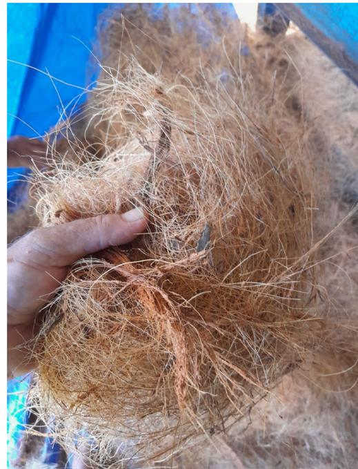
Figure 8 - Fibres en sortie de tamis
