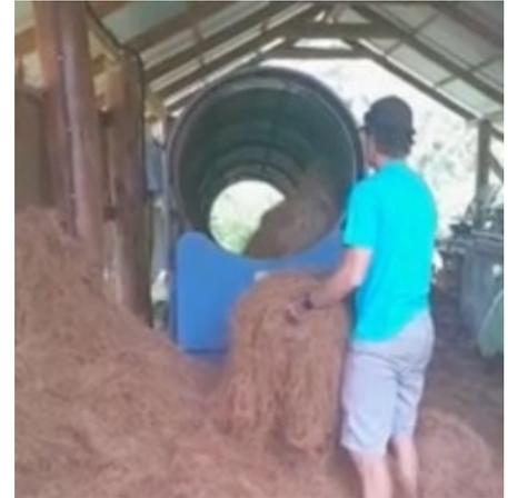
Figure 7 - Chargement de fibres dans le tamis
