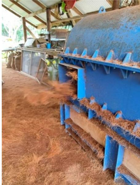
*Figure 5 - Fibres longues en sortie de défibreuse*
