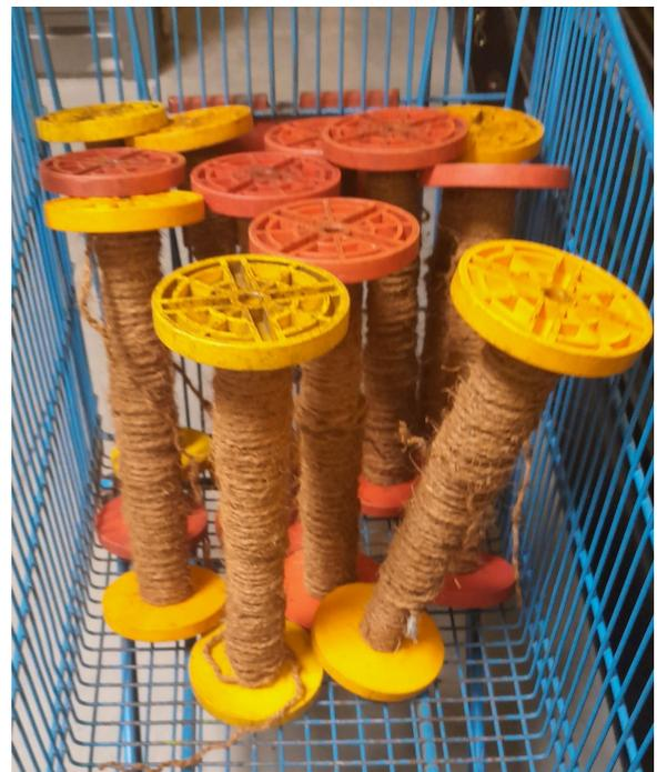
Figure 20 - Bobines prêtes à être tressés
