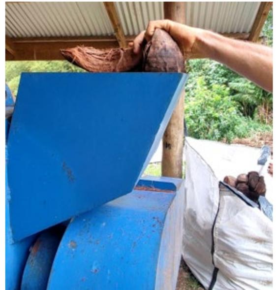
Figure 4 - Chargement de la défibreuse
