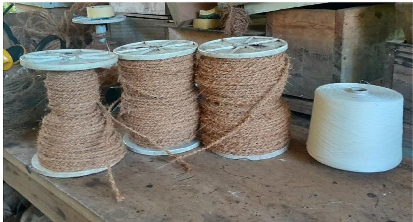
Figure 17 - Bobines de fils toronnés et bobine de guide (fil de lin à droite)
