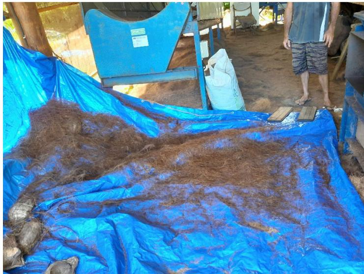
*Figure 6 - Fibres longues en sortie de défibreuse*
