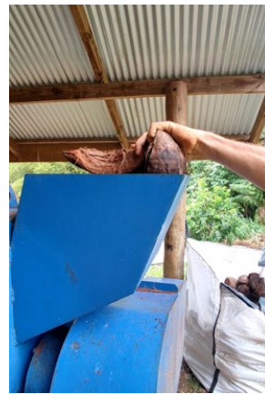
Figure 7 – Bourre de coco placée dans la défibreuse
